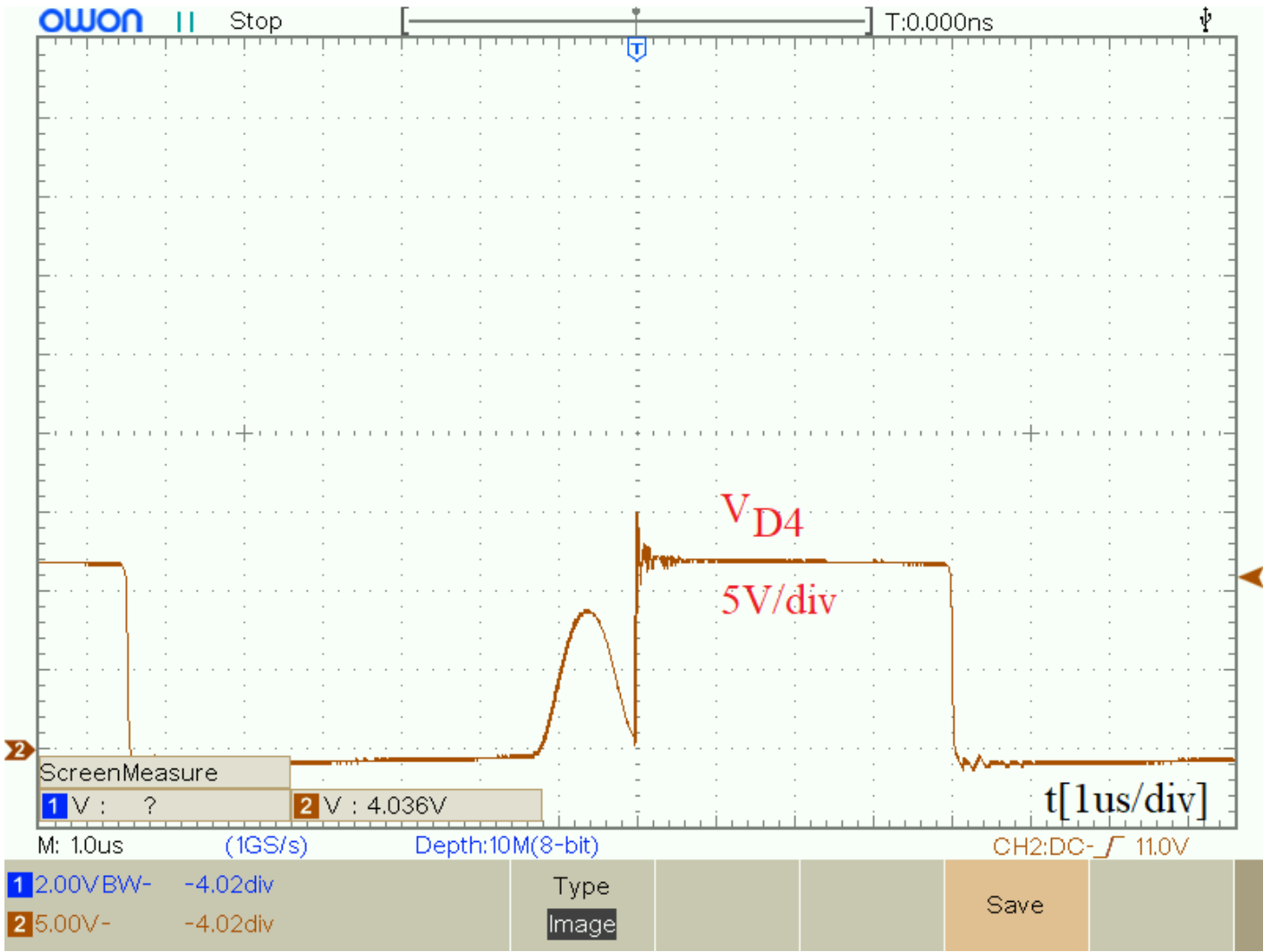
Şekil 17. Tam yük durumunda 5V_o 'a ait flyback çıkış diyodu D_4 'ün gerilim dalga şekli
