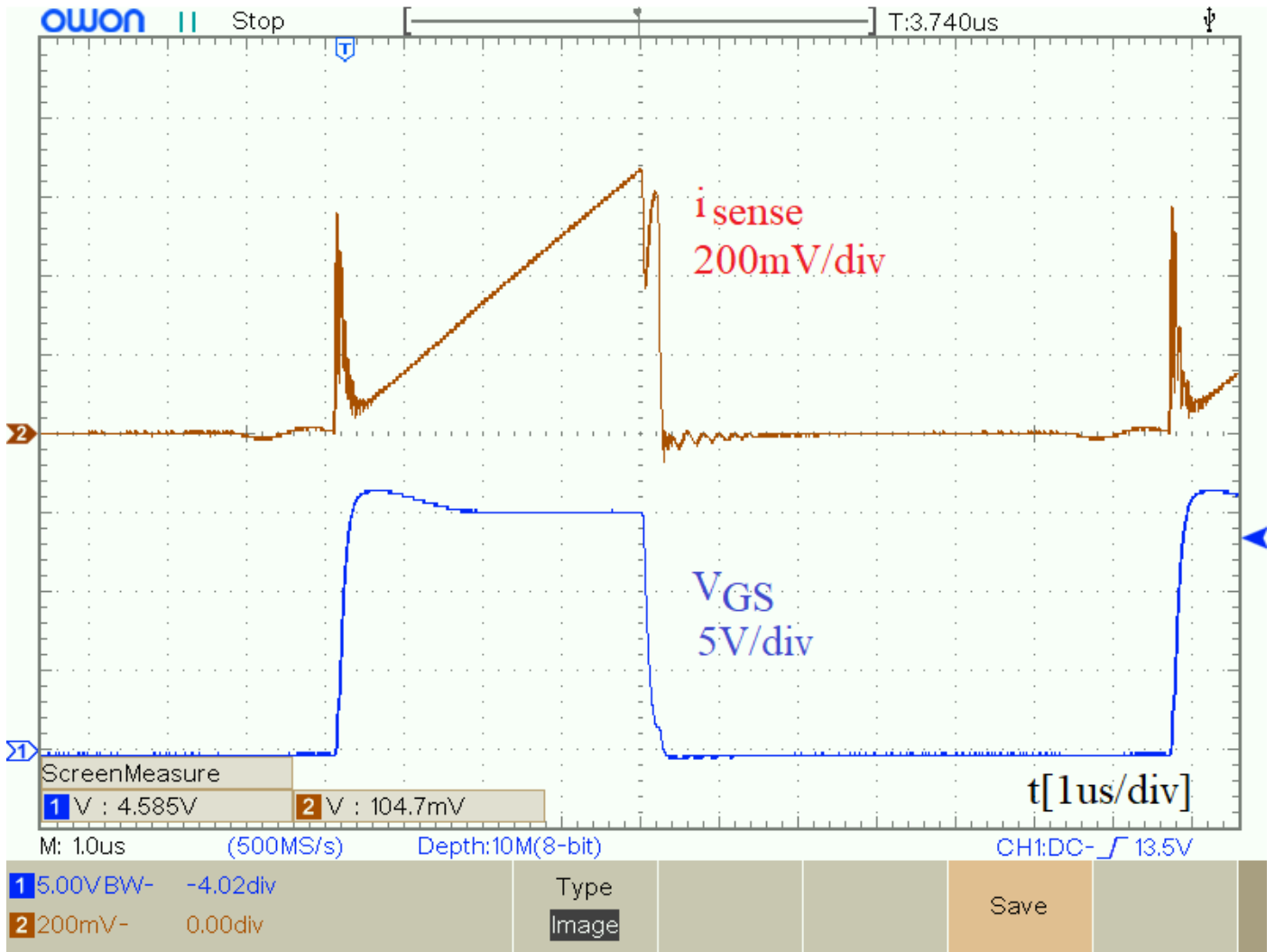
Şekil 14. Tam yük durumunda V_{GS} ve akım ölçüm dirençleri üzerindeki gerilim dalga şekilleri
